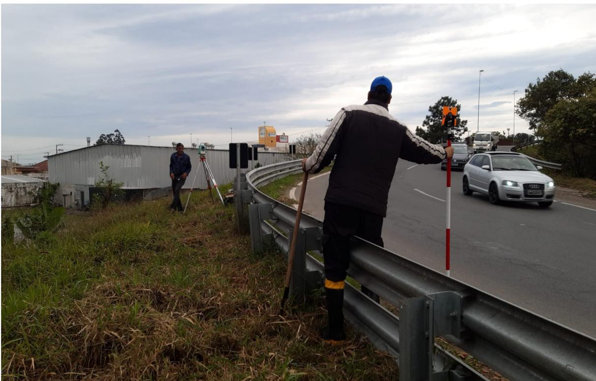
**Figura 3.9 – Levantamento Planialtimétrico e Cadastral**
