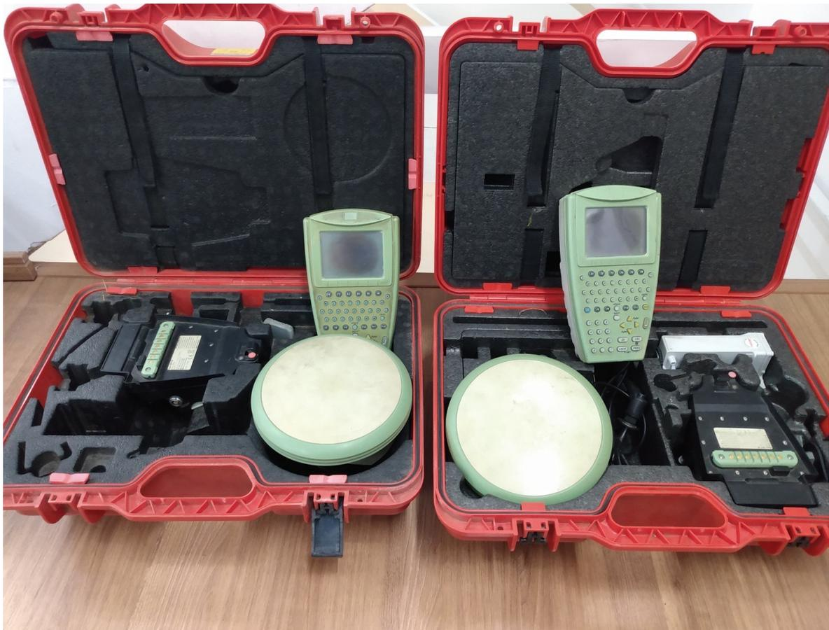
**Figura 3.3 – Rastreador GNSS – Marca Leica – Modelo 1200**
