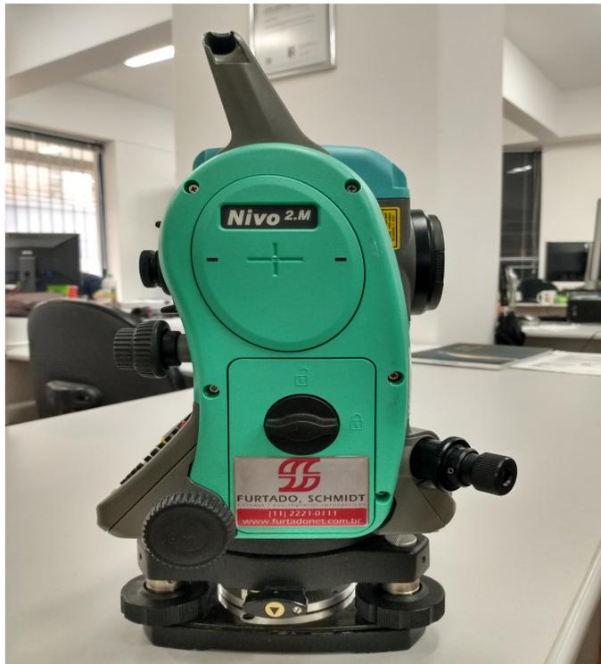
**Figura 3.4 – Estação Total marca Nikon, modelo Modelo NIVO-2M**
